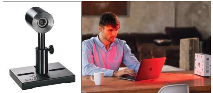
Abb. 2: Lichtblock nutzt den Ophir Sensor 2A-BB-9 um vergleichbare Messungen der Lichtintensitäten durchzuführen.
